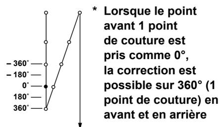
② Correction de la phase de désexcitation du solénoïde d'exécution de points arrière au début de la couture (Paramètre n° 52)
