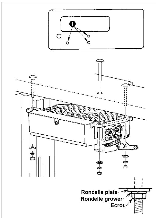
La description fournie ci-dessous fait référence au cas où le SC-920 est installé sur la table de la DDL-9000B. Pour utiliser toute autre tête de machine, installer la boîte de commande sur la table en vous reportant au mode d'emploi de la machine à coudre concernée.
