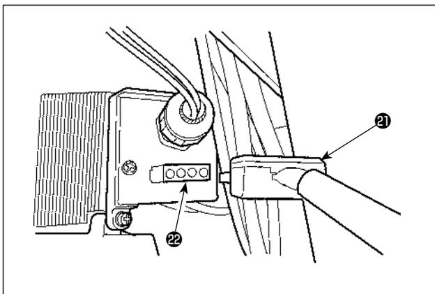
Brancher le cordon de sortie du moteur ②<sup>1</sup> au connecteur ②<sup>2</sup> situé sur le côté de la boîte.
