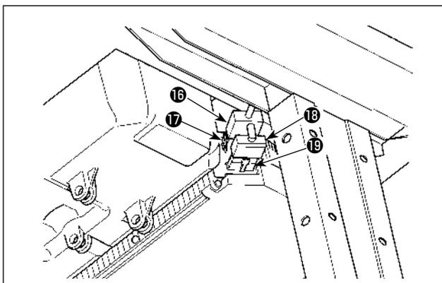
9) Connecter le connecteur à 4 broches **16** au connecteur **17** situé sur le côté de la boîte.
