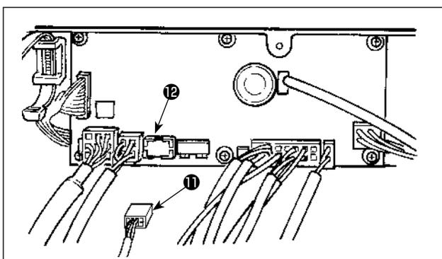
Le SC-920 est pourvu d'un connecteur pour le panneau de commande. Enfoncer à fond le connecteur ⑪ dans le connecteur (CN38) ⑫ sur la plaquette jusqu'à ce qu'il se verrouille en place tout en vérifiant le sens du connecteur ⑪.
