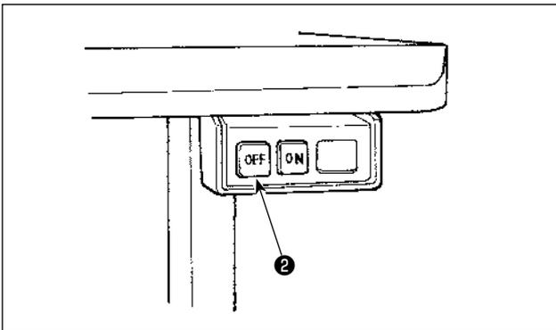
6) Après avoir terminé la couture, appuyer sur la touche OFF ② de l'interrupteur d'alimentation pour le mettre sur arrêt après s'être assuré que la machine est arrêtée.
