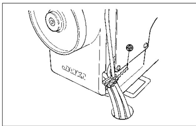
11) Regrouper les câbles de la tête de machine en un seul endroit au moyen d'un clip **20** fourni avec le panneau de commande comme indiqué sur la figure.
