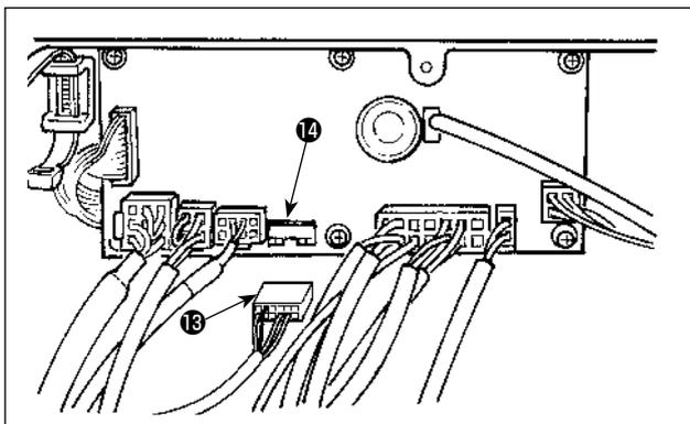
Connecter le connecteur de PK70 **13** au connecteur **14** (CN39 : 12 broches) de SC-920.
