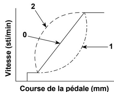
②⑦ **Fonction de déplacement en position d'arrêt HAUTE du mouvement initial (paramètre n° 90)**
