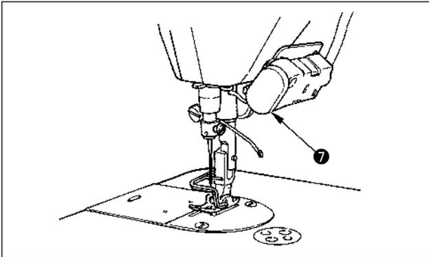
5) Sur certains types de tête de machine à coudre, l'entraînement arrière est exécuté sur pression de l'interrupteur touch-back ⑦. (La figure indiquée illustre le cas de la DDL-9000B.)
