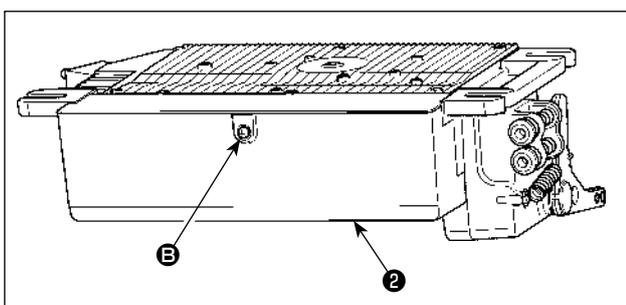
8) Fermer le couvercle **2** et le fixer en serrant la vis **B** avec un tournevis.
