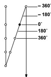
③ Correction de la phase de désexcitation du solénoïde d'exécution de points arrière à la fin de la couture (Paramètre n° 53)
