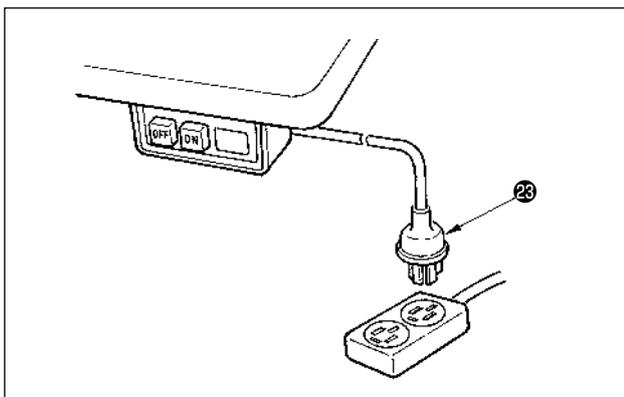
12) S'assurer que l'interrupteur d'alimentation est sur arrêt (OFF), puis brancher le cordon d'alimentation ②<sup>3</sup> provenant de l'interrupteur d'alimentation à la prise de courant.
