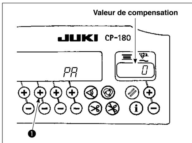
Chaque fois que le capteur, le ressort, etc. de la pédale est remplacé, veiller à exécuter l'opération suivante.
