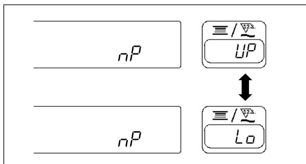
Lorsqu'on met la machine sous tension tout en appuyant sur la touche de compensation des points par le relevage/abaissement de l'aiguille ❶, la position d'arrêt quand la pédale est au neutre peut être changée.
