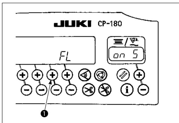
Lorsque le dispositif de releveur automatique (AK) est installé, cette fonction permet de l'activer.
